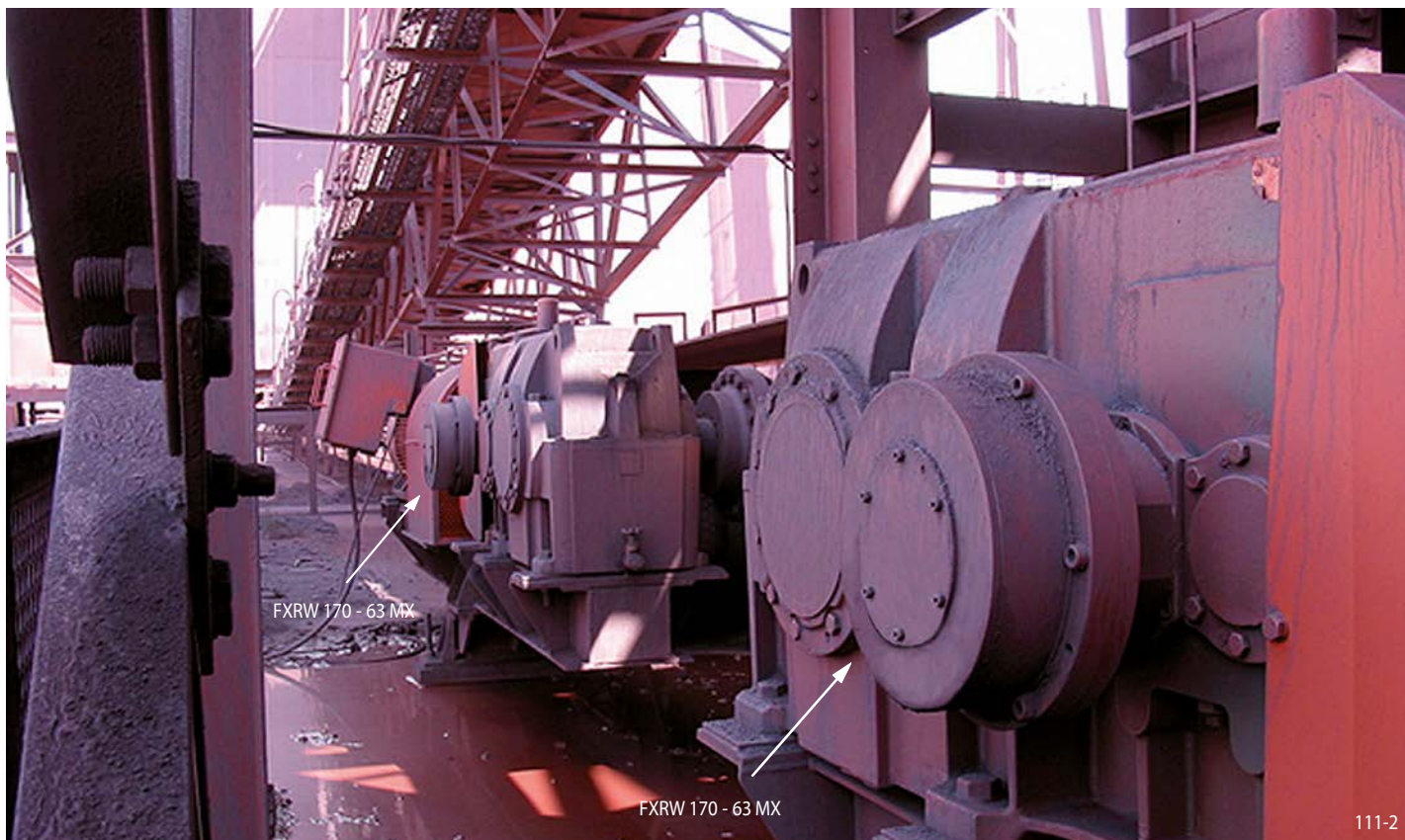
Bandanlage zur Förderung von Eisenerz in Südafrika; angetrieben von drei Getrieben mit RINGSPANN Rücklaufsperren FXRW 170 - 63 MX.
