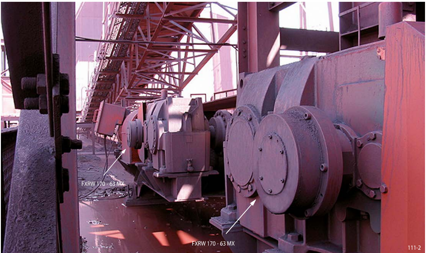
Convoyeur à bande de minerai de fer en Afrique du Sud, commandé par trois groupes d'entraînement équipés d'antidévireurs RINGSPANN FXRW 170-63 MX.
